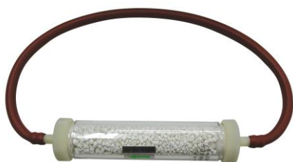
⑤ CO2 scrubber
